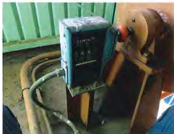
b. Llave de limite rotativa en guinche auxiliar
